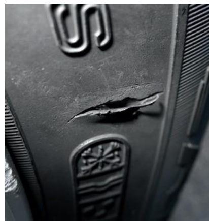
Corte profundo na parede do pneu
