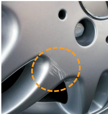
Calota ligeiramente riscada
