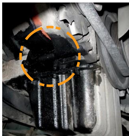
Perda de óleo com gotejamento
